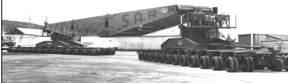
primjer željezničkog vozila za prijevoz specijalnih tereta
