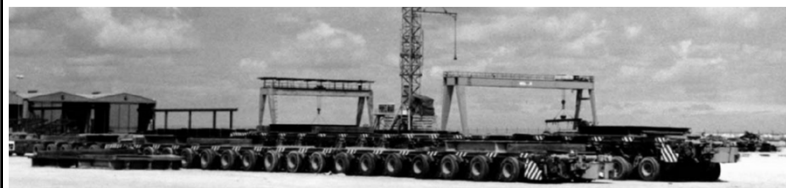
transport gotovih nosača Dubrovačkog mosta specijalnim vozilom
